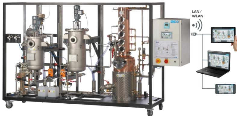
Ethanol Destillationskolonne ©G.U.N.T. Gerätebau GmbH
